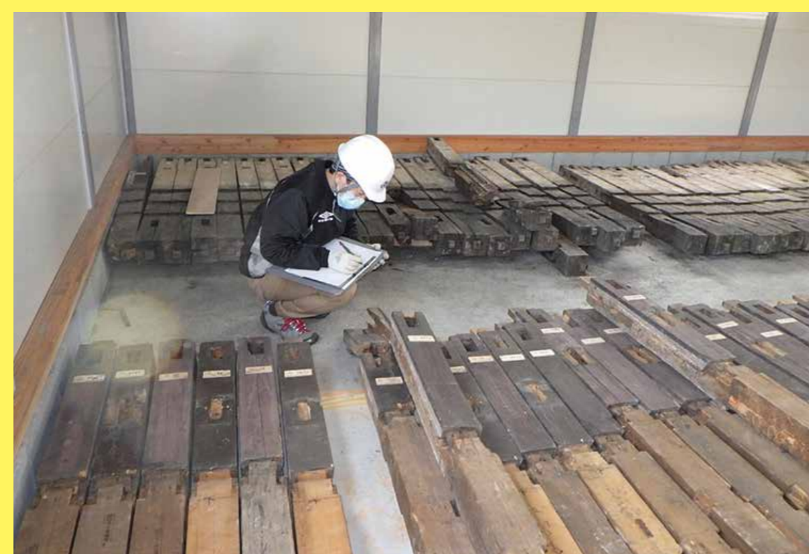
2 解体した部材の調査
